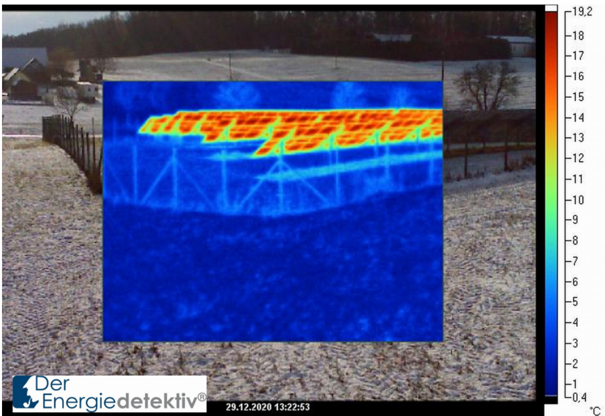
Bild 1 und Bild 2: Foto bzw. Wärmebild einer PVA Ende Dezember: Schnee am Boden und heiße Oberfläche der PVA.
